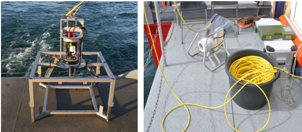
Abb. 1: Die neu entwickelte Dropkamera des BfN (links) und der BfN-Videoschlitten mit UW-Kabel (rechts).
