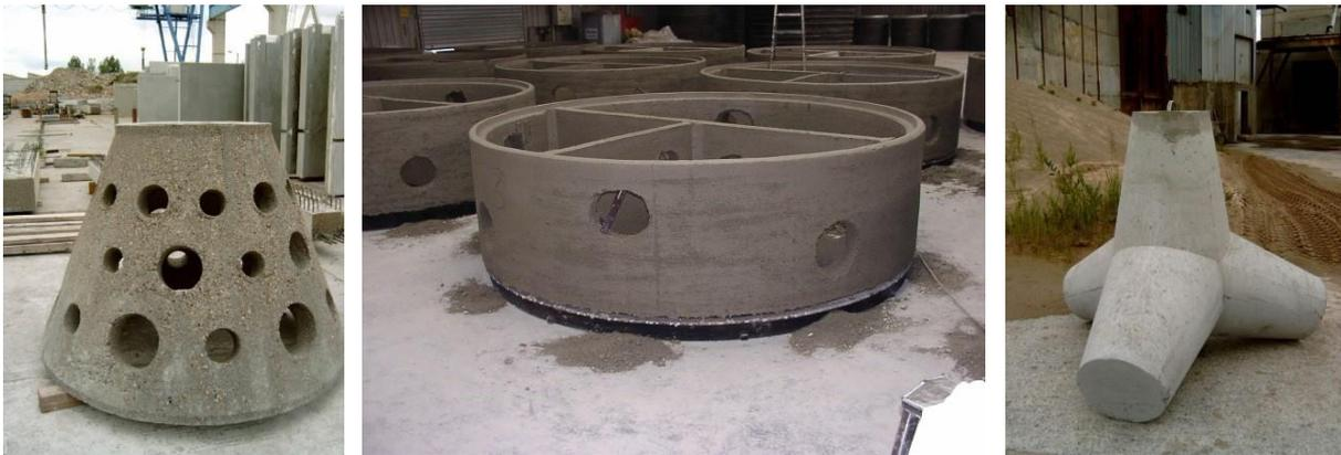
**Abb. 5:** Betonelemente – links: Riffkegel, Mitte: Ring, rechts: Tetrapode.
