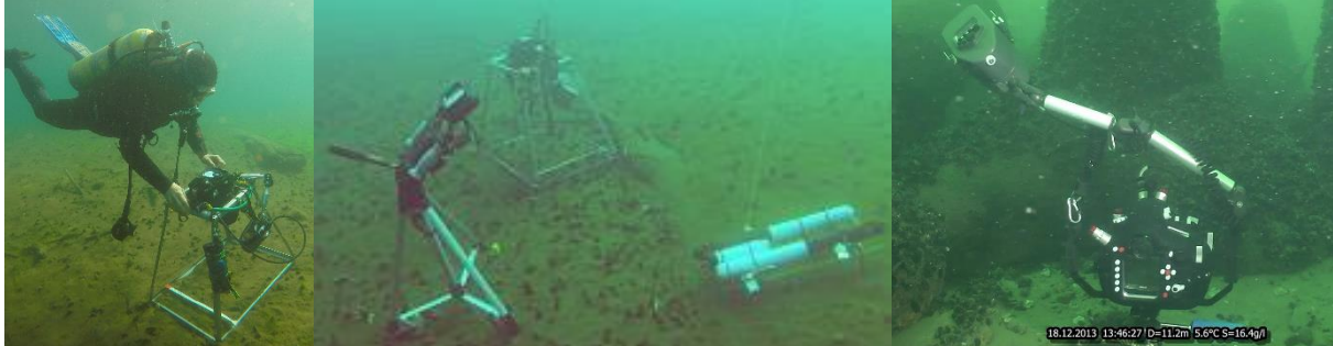
Abb. 18: Ausbringen der Beobachtungs- und Messtechnik zur Dokumentation des Filtrierverhaltens von Diplodon chilensis am Panguipullisee /Chile (Bild links und mitte) und Zeitrafferaufnahmen von Miesmuscheln ( Mytilus edulis ) am Ostseeriff Nienhagen (Bild rechts).
