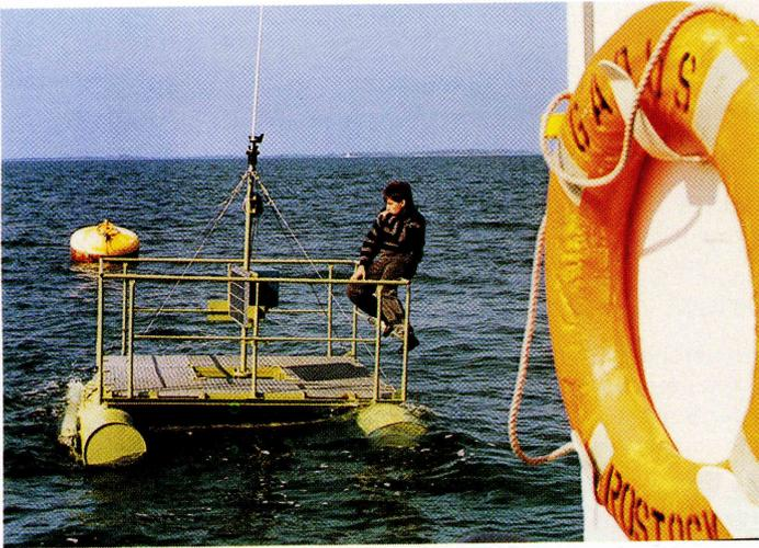
**Abb. 1** Ponton als Träger der Gewässersonde, zwischen 2 Festmachertonnen liegend. Man erkennt in der Mitte den Mast mit Solarzelle, Sensorsteuereinheit (blaue Kiste), Sensoren und Funkantenne
