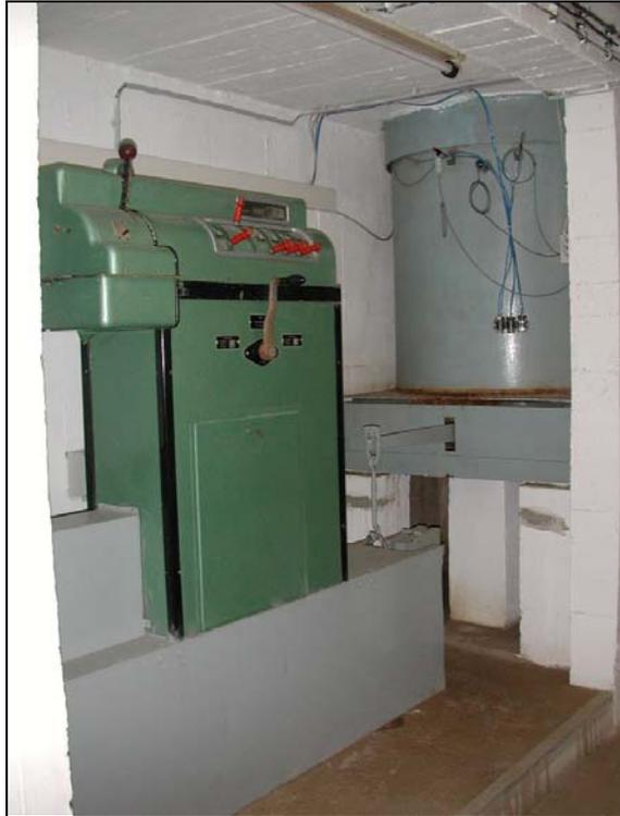
**Abb. 4** Blick auf ein Lysimeter mit Balkenwaage im Keller der Lysimeteranlage
