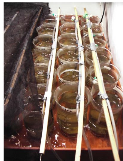
Abb. 11: Belüftungsanlage als Element des Versuchsaufbaus
